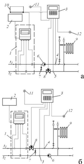
Рис. 1. СОТ с расположением регулирующего органа на подающей (а) и на обратной (б) магистрали: 1 – теплосчетчик; 2 – устройство для вывода данных на печать; 3 – термоконтроллер; 4, 5, 11, 12 – датчики температуры теплоносителя на входе и выходе из системы отопления, наружного и внутреннего воздуха соответственно; 6 – циркуляционный насос; 7 – обратный клапан; 8 – регулирующий орган; 9 – приборы отопления; 10 – ПК
