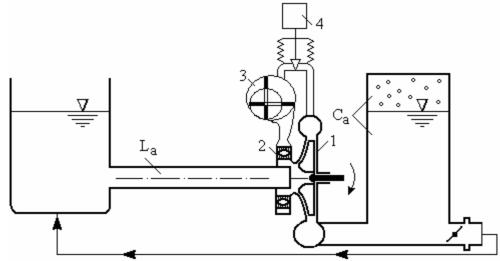
Рис. 5. Схема импульсной рециркуляции расхода жидкости, в которой: 1 — центробежный насос, 2 — узел закрутки потока, 3 — ротационный насос, 4 — регулятор импульсов
