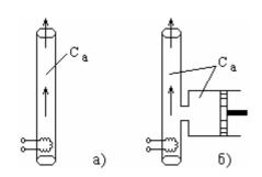
Рис.1. Труба Рийке с расположением спирали электронагревателя на входе: а) автоколебания отсутствуют; б) возбуждаются при увеличении  $C_{\rm a}$
