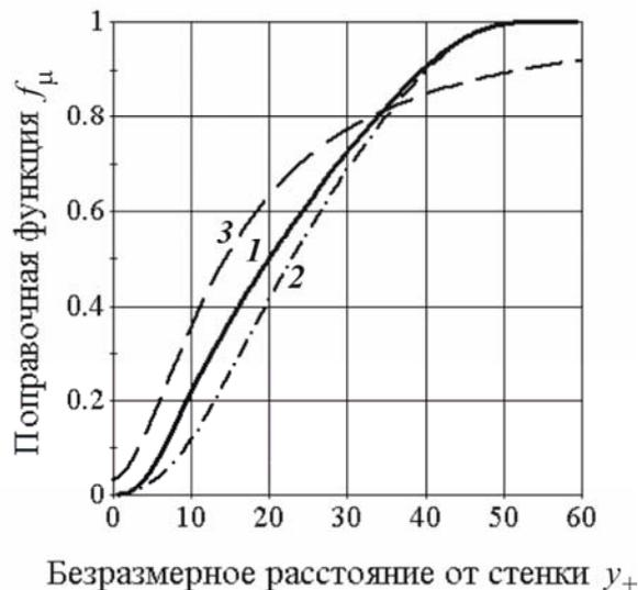
Рис. 2. Поправочная функция  $f_\mu$ : 1 – уточненная, 2 – расчетная, 3 – Лаундер–Шарма
