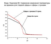
Рис.6. Изменение температуры при охлаждении сфер с гладкой поверхностью и луночным рельефом в воде,  $\Delta T_{\text{HEJ}}$  =6 K
