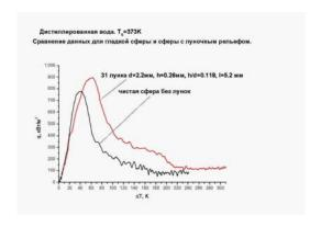
Рис.7. Влияние луночного рельефа на кривую кипения воды  $T_S = 373 \, \mathrm{K}$
