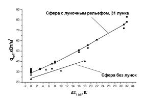
Рис.3. Влияние луночного рельефа на коэффициент теплоотдачи при пленочном кипении фреона  $113.T_S$ =321K
