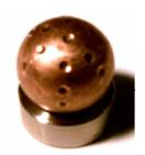
Рис.2. Медная сфера с лунками. 31 лунка, d=2,5 мм, h=0,41 мм, h/d=0,164 мм l=5,2 мм
