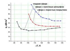
Рис. 5. Теплообмен при пленочном кипении фреона 113 на сферах с различным рельефом поверхности
