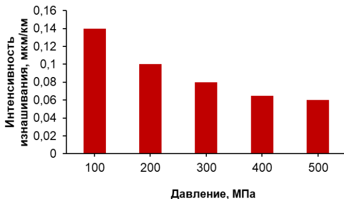
Рисунок 3. – Зависимость интенсивности изнашивания порошковых покрытий на основе систем «медь – УНТ» от давления электродов
