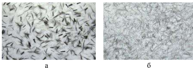
Рис. 3. Распределение УВ (а) и Cu-УВ (б) в полимерном связующем
