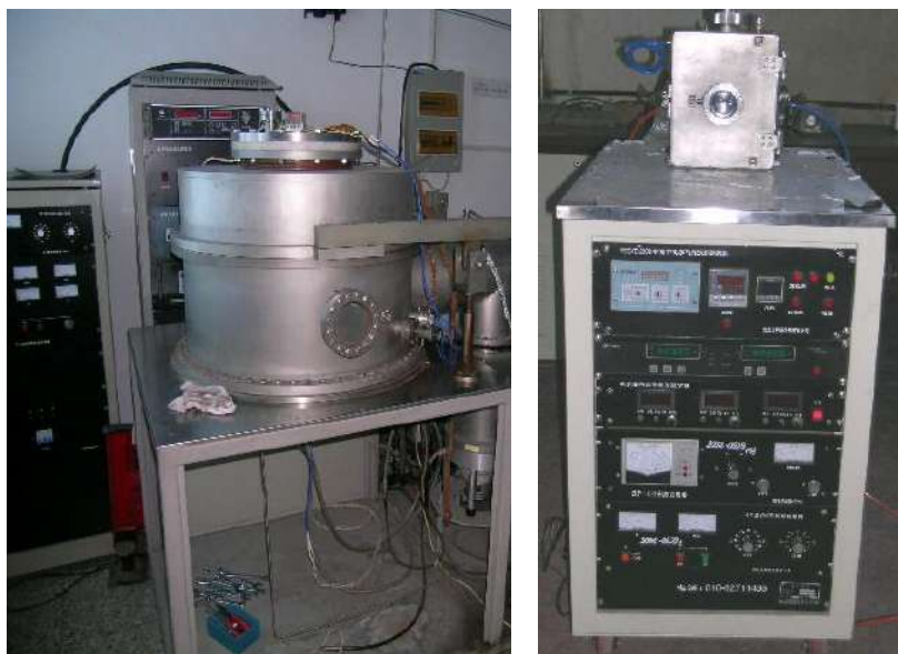
Рис. 2. CVD- реакторы для синтеза углеродных нанотрубок в совместной белорусско-китайской лаборатории Института новых материалов Академии наук КНР (г. Цзинань)
