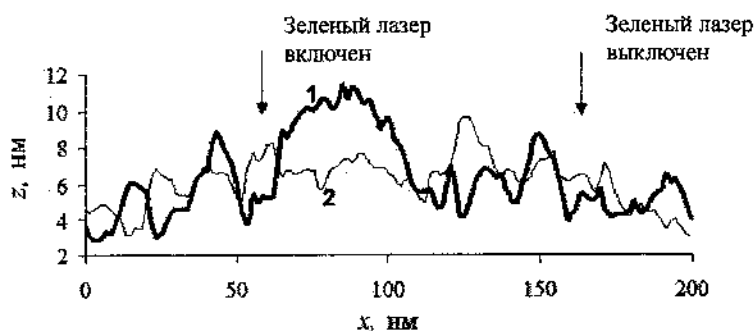
Рис. 4. Сечения, проведенные по линиям AA (линия 1) и BB (линия 2) СТМ-изображения, приведенного на рис. 3
